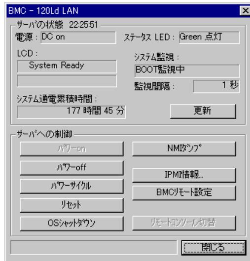
これらの制御は右図の BMC ダイアログボックスから操作します。
