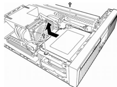
4. 実装済みのハードディスクドライブからケーブルを取り外します。
