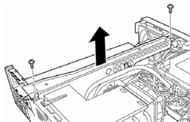
4. 取り付けるスロットのカバーを取り外します。
