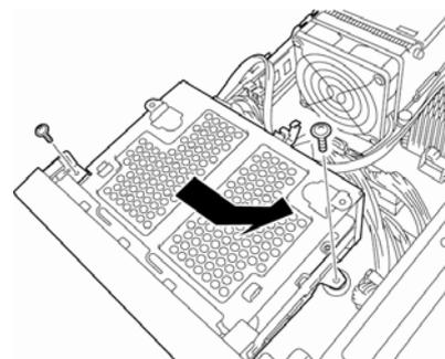
6. ネジ4本でハードディスクドライブを取り付けます。
