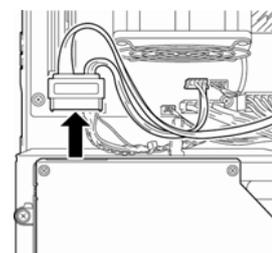
3. ネジ2本を外して光ディスクドライブを取り外します。
