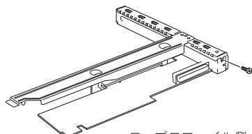
6. ディスクアレイコントローラ(N8103-91)を取り付ける場合、オプションの内蔵SASケーブル(K410-151(00))を使用し、ケーブルをマザーボードに接続する。
