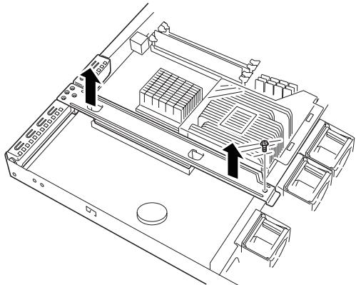
3. ライザーカードからネジ1本を外し、増設スロットカバーを取り外す。
