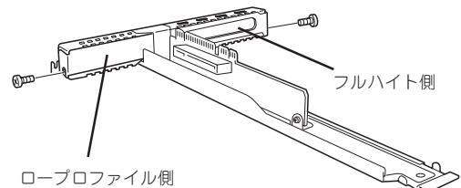
4. ライザーカードにPCIボードを取り付ける。
