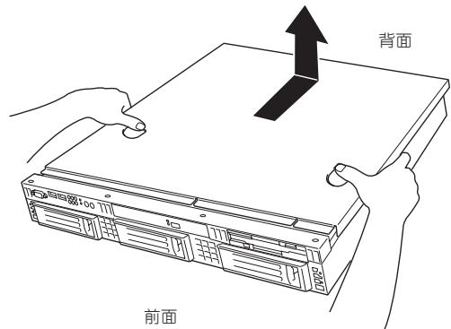
トップカバーを取り付けるときは、トップカバーにあるフックと本体のフレームにある穴をあわせてていねいに本体に置いた後、前面へ向けてスライドさせてください。
