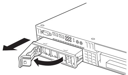
4. ハードディスクドライブを取り外したまま本装置を使用する場合は、空いているスロットにダミートレーを取り付ける。
