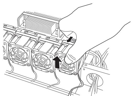
5. オプションファン上部のプラスチック部分を軽く押しながらつまみ、オプションファンの下部の突起部分を溝に合わせ、軽く押しながら装着する。
