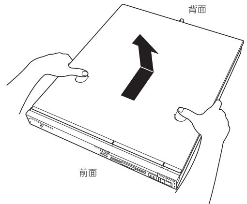
トップカバーを取り付けるときは、トップカバーにあるフックと本体のフレームにある穴をあわせてていねいに本体に置いた後、前面へ向けてスライドさせてください。
