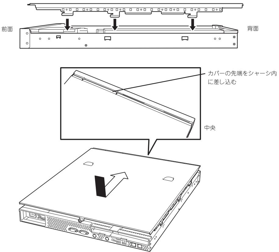
トップカバーの取り付け後、背面のネジで本体に固定します。
