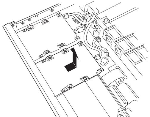
6. ハードディスクドライブの基板面を上にして置き、その上にディスクベイを静かに置く。
