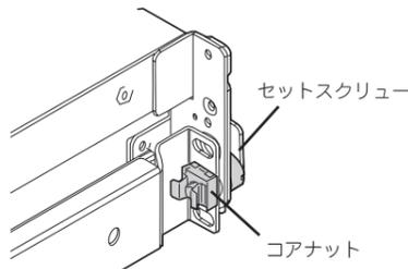
本体の運搬時にスライドレールが外れないようにセットスクリューとコナナットで固定されています。ラックへの取り付け前に左右に付いているコナナットを取り外してください(コナナットを手でしっかりと持ちながらセットスクリューを回してください)。
