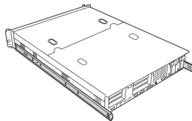
レールアセンブリは、取り外したインナーレールに再度取り付けます。どちら側のインナーレールから取り外したものがわかるように印を付けるなどして区別してください。複数の本装置を設置する際もどの装置のどちら側のインナーレールから取り外したものがわかるように区別してください。
