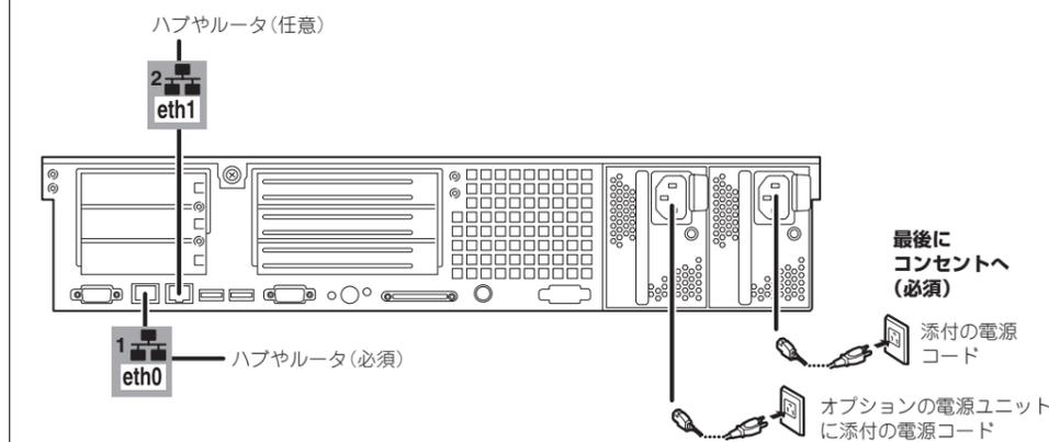
**重要** LANポート1を必ず運用時のネットワークに接続してください。初期導入時のセットアップでは、LANポート1(システムからはeth0ポートとして扱われます)を使用してセットアップを進めます。LANポート2(eth1)は初期導入のセットアップを完了後、Management Consoleの[システム]→[その他]→[ネットワーク]で設定できる拡張用ポートです。
