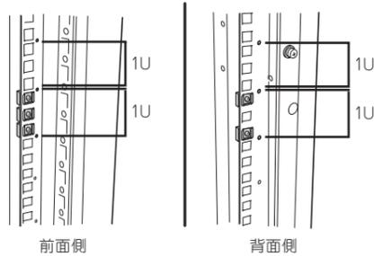
コナナットは前面側に各3個、背面側に各2個を取り付けます。本体はラックの「2U」分の高さを使用します。レールアセンブリは2Uのうち、下側の1Uに固定します(ラックのフランジ部には1U単位に刻印などの印があります)。
