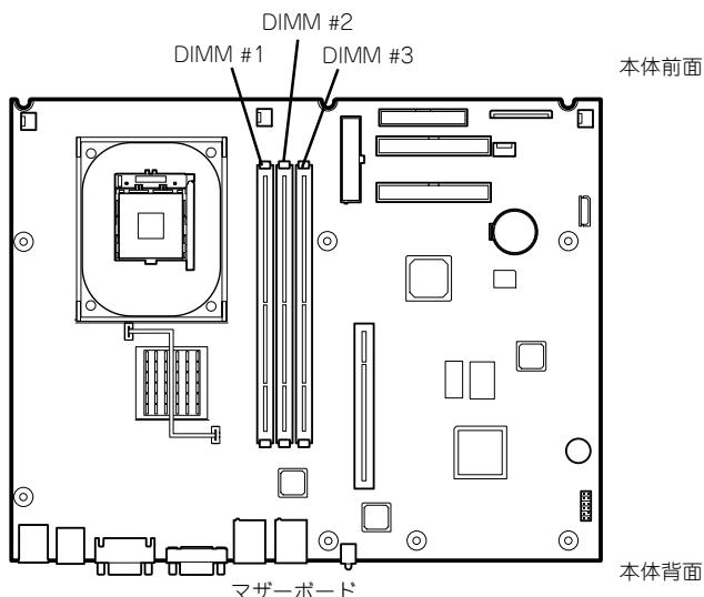
出荷時には、DIMM #1にDIMMを搭載しています。
