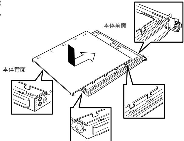
ラックへ収納する際は、本体側面にあるマウントプラケットをサポートプラケットに差し込みながらラックへ押し込んでください。完全に押し込んだら、前面の両側にあるセットスクリューで固定します。
