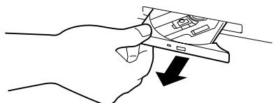
4. CD-ROMの文字が印刷されている面を上にしてトレーの上に静かに、確実に置く。
