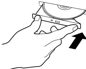
CD-ROMの取り出しがは、CD-ROMをセットするときと同じようにCDトレーイJECTボタンを押してトレーを引き出します。
