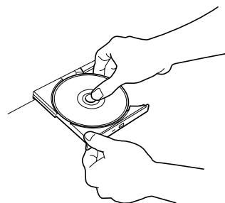
右図のように、片方の手でトレーを持ち、もう一方の手でトレーの中心にあるローター部分を押さえながらCD-ROMの端を軽くつまみ上げるようにしてトレーから取り出します。
