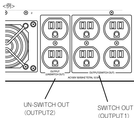
UPSを制御するアプリケーション(ESMPRO/UPSCControllerなど)から電源の制御をしたい場合は、SWITCH OUTに電源コードを接続します。
