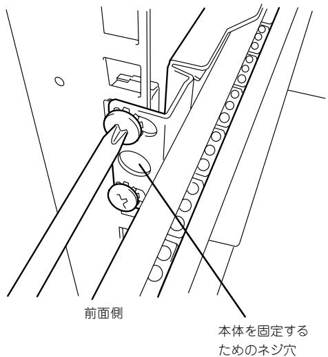
3. レールの長さを調節するネジを固定する。
