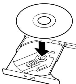
5. 右図のように片方の手でトレーを持ちながら、もう一方の手でトレーの中心にあるローター部分にCD-ROMの穴がはまるように指で押して、トレーにセットする。
