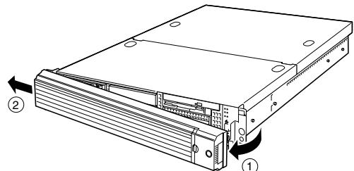
フロントベゼルを取り付けるときは、フロントベゼルの左端のタブを本体のフレームに引っかけるようにしながら取り付けます。取り付けた後はセキュリティのためにもキーでロックしてください。
