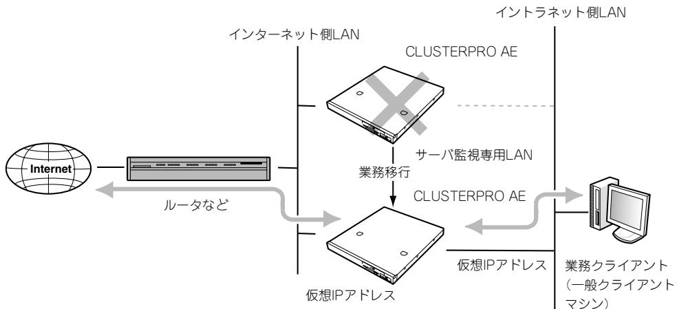
DMZを使用する場合もイントラネット、インターネット同様に仮想IPアドレスが引き継がれます。
