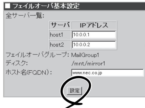
3. CLUSTERPROマネージャで切り換えミラーディスクの再構築が完了後、フェイルオーバグループをhost2.nec.co.jpに移動する。
