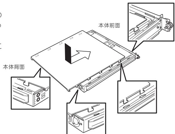
あるマウントブラケットをサポートブラケットに差し込みながらラックへ押し込んでください。完全に押し込んだら、前面の両側にあるセットスクリューで固定します。
