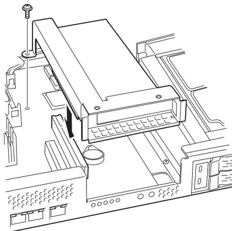
**10. 取り外した部品を取り付ける。****11. 本装置の電源をONにしてPOSTの画面でボードに関するエラーメッセージが表示されていないことを確認する。****12. 取り付けたボードに搭載されているBIOSコンフィグレーションユーティリティを起動してボードのセットアップをする。**
