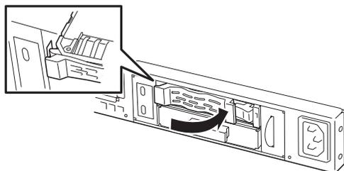
5. スロット2に取り付ける場合は、ダミートレーの取っ手を持ち、ダミートレーを取り外す。
