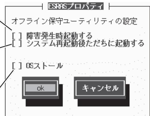
スペースバーでWDTによるOSストール監視の有効/無効を設定します。チェック時に監視する。アンチェック時は監視しない。設定は再起動後に有効になる。
