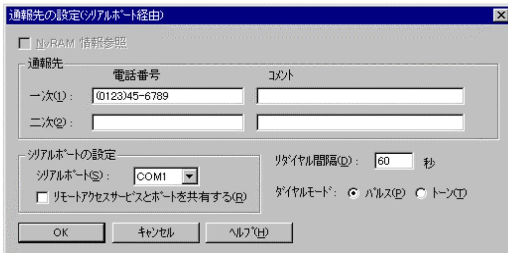
12) モデムが接続されているシリアルポートやモデムの設定を行います。[OK]ボタンをクリックすると[マネージャからのエクスプレス通報(ダイヤルアップ経由)の設定]ダイアログボックスに戻ります。
