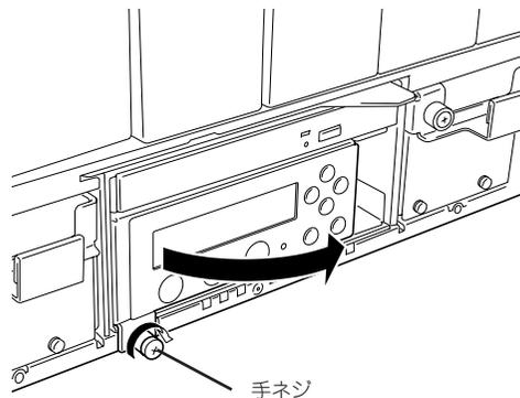
3. EMカードを実装するスロットを確認し、EMカードの取っ手の部分を押しながら挿入する。
