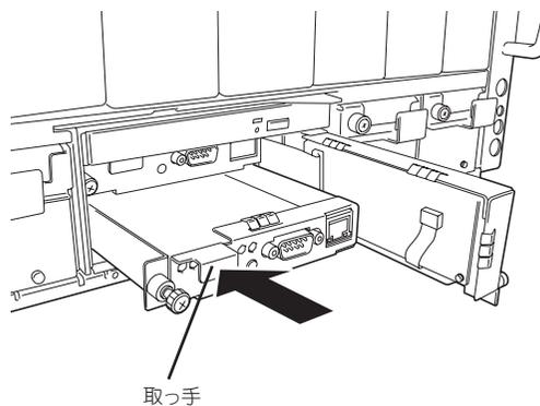
4. EMカードの左端にある手ネジで本体装置に固定する。
