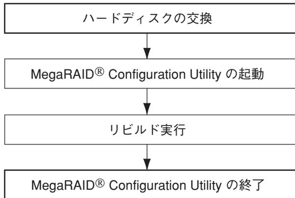
1. ハードディスクを交換し、ストリーミングサーバを起動させる。
