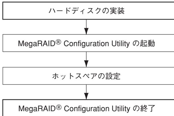
1. ホットスペア用のハードディスクを実装し、ストリーミングサーバを起動させる。
