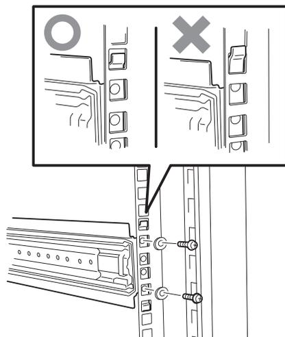
4. 手順1でゆるめたネジを締めてスライドブラケットを固定する。
