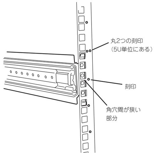
ラックの奥行き分の長さが足りない時は、先端にあるネジ2本を外してスライドブラケットを延ばしてください。
