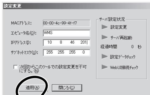
7. [IPアドレス]欄にIPアドレス、[サブネットマスク]欄にサブネットマスクを入力する。
