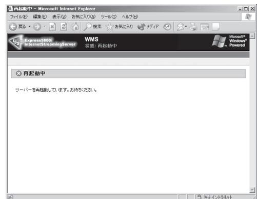
「再起動中」の画面が表示されます。再起動が完了すると、自動的にWebUIに再接続します(5分から10数分程度)。再接続されない場合やエラーとなった場合は、一度ブラウザを終了し、WebUIを再起動してください。それでもアクセスできない場合には、本体のPOWERスイッチを押して終了後、電源を入れ直してください。詳細は1章の「強制電源OFF」や「電源のON」を参照ください。
