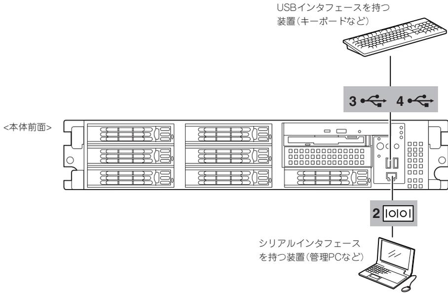
**チェック** 接続しようとしているケーブルを確認してください。本体前面の「シリアルポート2コネクタ」は、RJ-45コネクタと同じ形状をしています。LANケーブルを接続しないよう注意してください。
