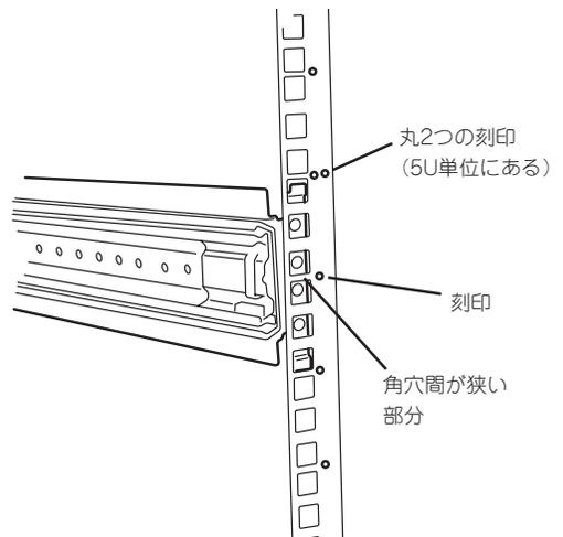
ラックの奥行き分の長さが足りない時は、先端にあるネジ2本を外してライドブラケットを延ばしてください。
