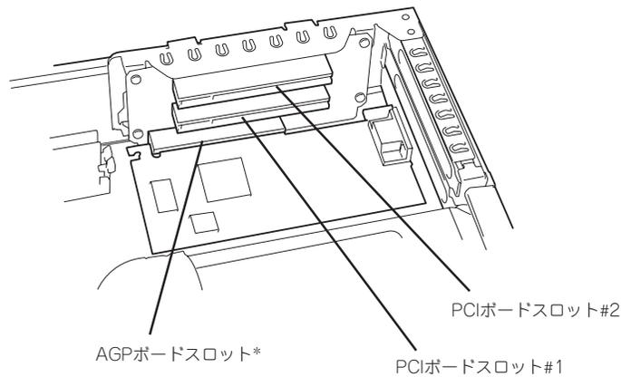
\* AGPボードスロットには標準でディスクアレイコントローラボードが取り付けられています(他のディスクアレイコントローラボードと交換はできません)。
