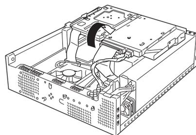
6. CD-ROM/FDDベイをしっかりと押さえ、CD-ROMドライブのインターフェースケーブルと電源ケーブルを外す。
