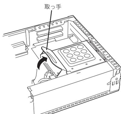
9. 取っ手をもち、ハードディスクベイの前側を少し持ち上げ、もう一方の手でハードディスクベイを支えながら斜め上方へ引き出して外す。
