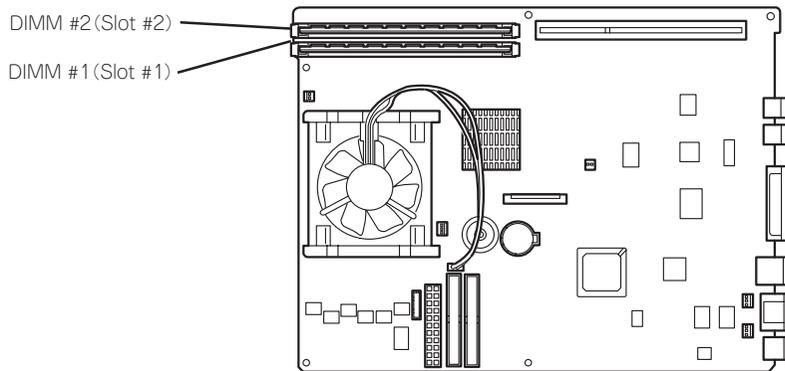
DIMMは1枚単位で取り付けられます。また、DIMMソケットのSlot #1、Slot #2の順に取り付けてください。
