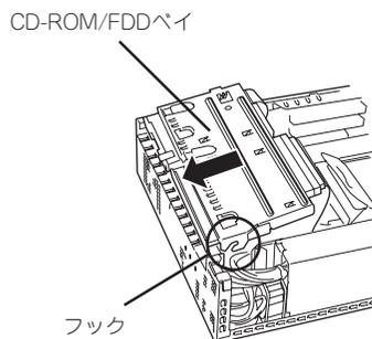
20. 次の点について、CD-ROM、フロッピーディスクドライブの取り付け状態やケーブルの接続状態を確認する。
