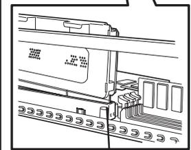
① 接続端子のエッジをスロットの端に押しつけて位置を決める
