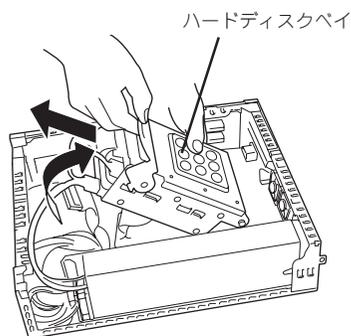
10. 搭載済みのハードディスクに接続しているケーブルをすべて取り外す。
