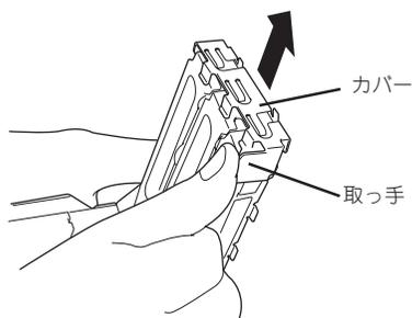
6. 取り付けるスロットと同じ位置(高さ)にあるブランクカバーを取り外す。
