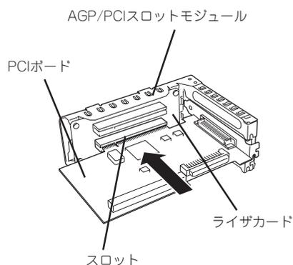
8. AGP/PCIスロットモジュールのカバーを取り付ける。
