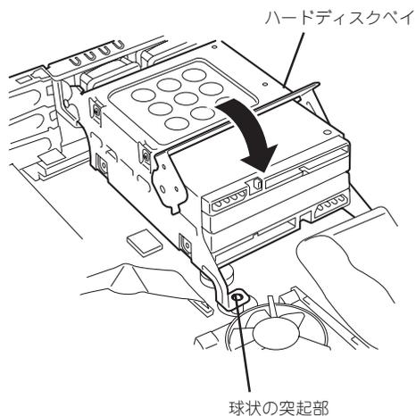
17. 次の点について、ハードディスクの取り付け状態やケーブルの接続状態を確認する。
