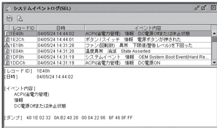
上段に一覧が表示され、下段に一覧表示で選択されたエントリの詳細情報が表示されます。再読み込みアイコン[
