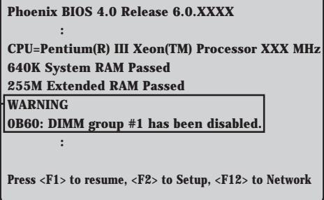
メモリの故障を示すメッセージ(例ではDIMM group #1(4枚)中のいずれかのDIMMが故障した場合の表示)
