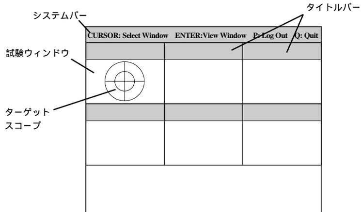
システムバーには、試験中に時間などの情報が表示されます。診断終了後には、ウィンドウを操作するキーの説明が表示されます。
