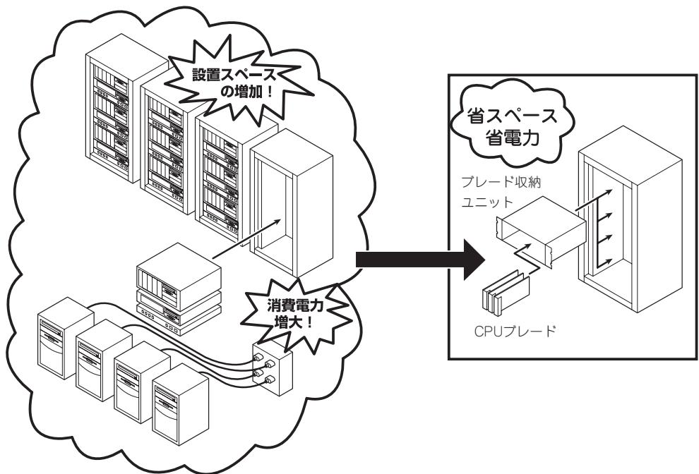
CPUブレードおよびCPUブレードに接続されるハードディスクドライブは、ワンタッチで取り付けることができ、電源やケーブルの配線・接続の必要はありません。
