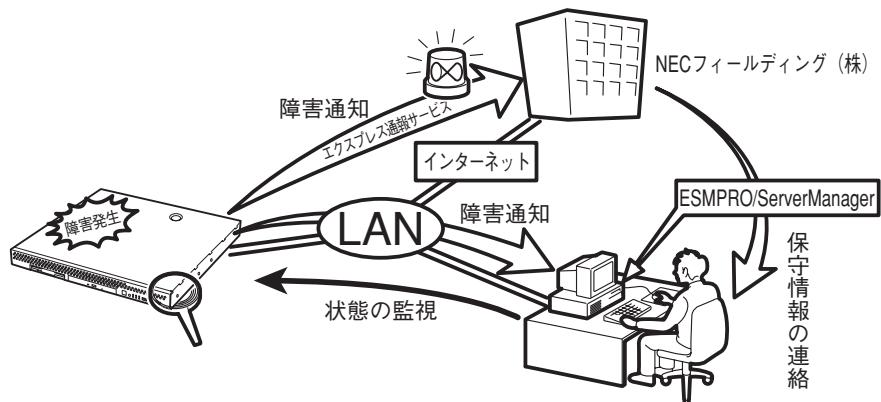
なお、本装置に障害が発生した際に、NECフィールディング（株）がアラート通報を受信して保守を行う「エクスプレス通報サービス」を利用すれば、低コストでExpress5800シリーズの障害監視・保守を行うことができます。
