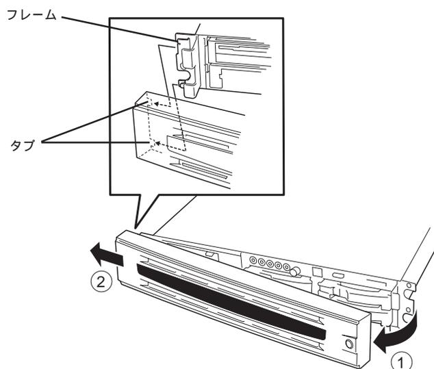
フロントベゼルを取り付けるときは、フロントベゼルの左端のタブを本体のフレームに引っかけるようにしながら取り付けます。取り付け後はセキュリティのためにもキーでロックしてください。
