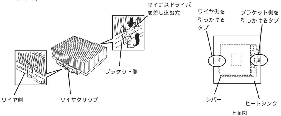
11. ヒートシンクが水平に取り付けられていることを確認する。
