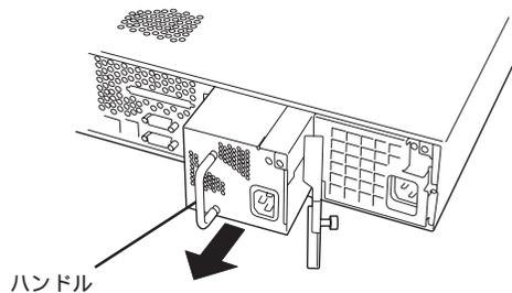
4. 電源ユニットを交換せず1台の電源ユニットで運用する場合は、「取り付け」の手順4で取り外したカバーを取り付ける。
