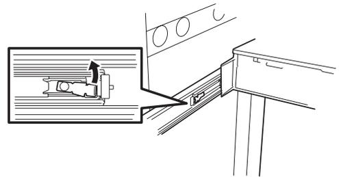
初めての取り付けでは各機構部品がなじんでいないため押し込むときに強い摩擦を感じることがあります。強く押し込んでください。
