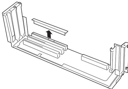
5. 取り付けるスロットと同じ位置にある増設スロットカバーを固定しているネジ1本を外す。
