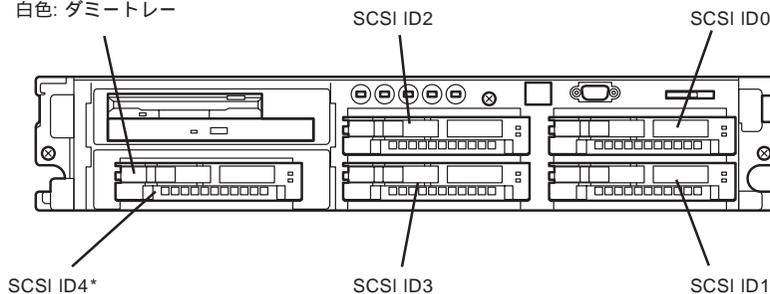
\* 5.25インチデバイスを搭載しているときは、上段の3.5インチフロッピーディスクドライブとCD-ROMドライブがSCSI ID4のスロットを専有するためハードディスクベイとしての使用はできません。
