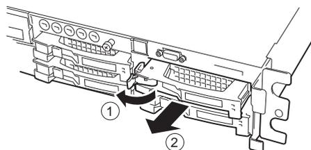
ディスクアレイ構成の場合、故障したハードディスクの交換後、交換した新しいディスクに交換前までの情報を記録することにより、故障を起こす以前の状態に戻すことのできるオートリビルド機能を使用することができます。
