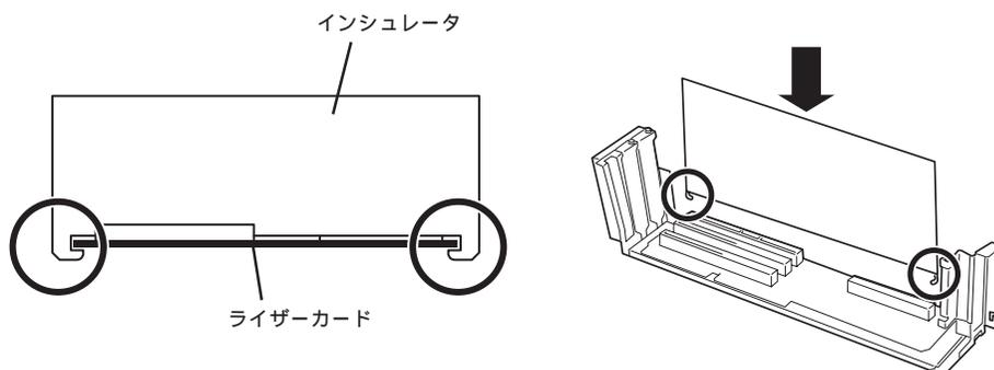
PCIボードスロット#2と#4に取り付けたボードを取り外して運用する場合は、インシュレータも取り外してください。
