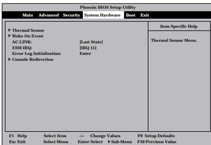
System Hardwareメニューで設定できる項目とその機能を示します。「Thermal Sensor」と「Wake On Event」、「Console Redirection」は選択後、<Enter>キーを押してサブメニューを表示させてから設定します。
