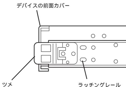
10. フロッピーディスク/CD-ROMドライブベイを下のスロットへ差し込む。
