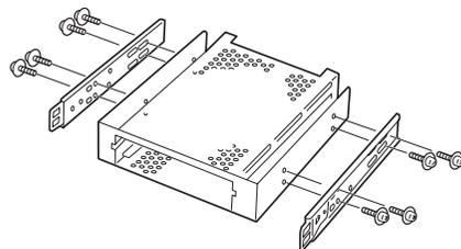
9. 取り外したラッチングレールを5.25インチデバイスに取り付ける。
