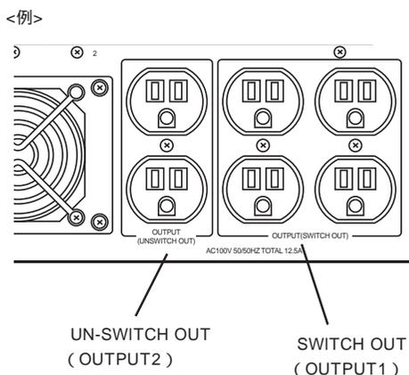
本装置の電源コードをUPSに接続している場合は、UPSからの電源供給と連動(リンク)させるためにExpressサーバのBIOSの設定を変更してください。
