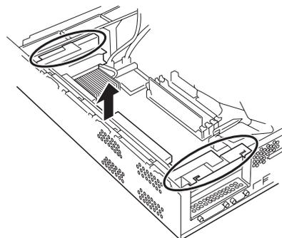
4. ボードを取り付けるスロットを確認し、コネクタキャップを取り外す。
