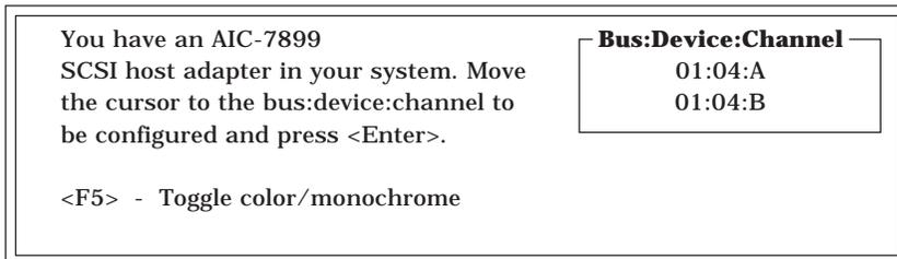
マザーボードのSCSIコントローラにはチャンネルが2つあります。標準構成ではチャンネルA(01:04:A)は内蔵ハードディスク用コネクタを、チャンネルB(01:04:B)は5.25インチデバイスのコネクタを示します。
