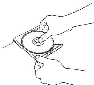
右図のように、片方の手でトレーを持ち、もう一方の手でトレーの中心にあるローター部分を押しえながらCD-ROMの端を軽くつまみ上げるようにしてトレーから取り出します。
