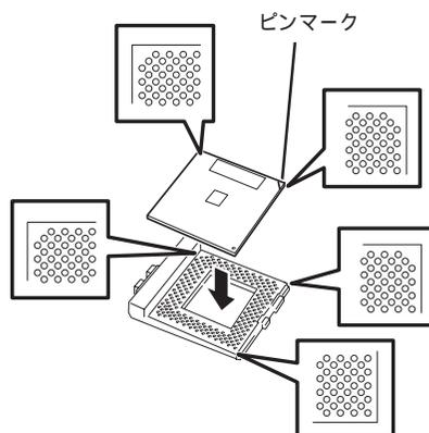
6. CPUを軽くソケットに押しつけてからレバーを倒して固定する。
