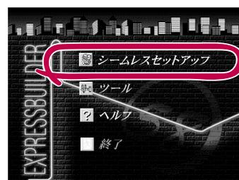
シームレスセットアップは、セットアップを開始する前にセットアップに必要な情報を編集しフロッピーディスクに保存し、セットアップの際にその情報を逐一読み出して自動的に一連のセットアップを進めるといふものです。このとき使用されるフロッピーディスクのことを「セットアップパラメータFD」と呼びます。
