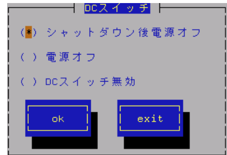
コントロールパネル(ESMpowersw)の[DC スイッチ]画面
