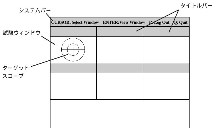
システムバーには、試験中に時間などの情報が表示されます。診断終了後には、ウィンドウを作成するキーの説明が表示されます。
