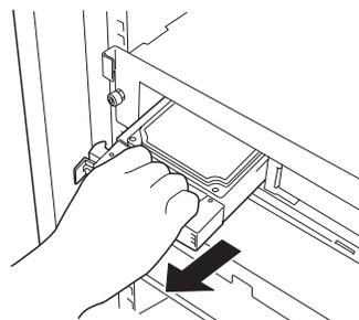
ディスクアレイ構成の場合、故障したハードディスクの交換後、交換した新しいディスクに交換前までの情報を記録することにより、故障を起こす以前の状態に戻すことのできるオートリビルド機能を使用することができます。
