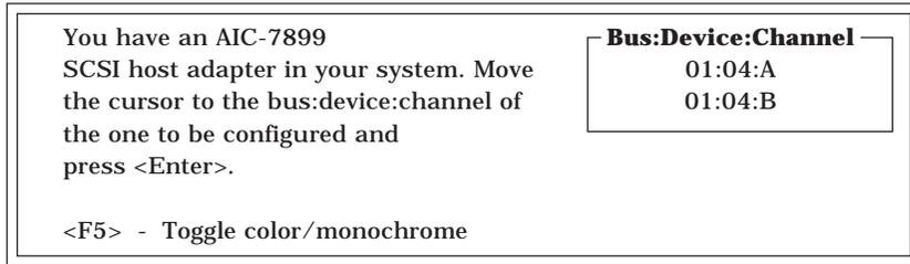
マザーボードのSCSIコントローラにはチャンネルが2つあります。チャンネルA(01:04:A)はUltra 160/m SCSI用コネクタ(ハードディスク用)を、チャンネルB(01:04:B)は外部SCSI(Wide)コネクタ用を示します。
