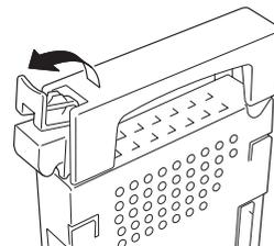
7. ハードディスクのハンドルにあるレバーを完全に開いた状態にしてハンドルをしっかりと持ってスロットへ挿入する。
