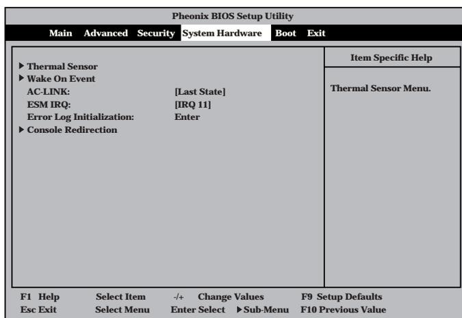
System Hardwareメニューで設定できる項目とその機能を示します。「Thermal Sensor」と「Wake On Event」、「Console Redirection」は選択後、<Enter>キーを押してサブメニューを表示させてから設定します。
