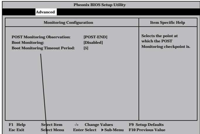
Boot Monitoringを「Enabled」にしたときのみ表示する
