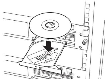
5. 右図のように片方の手でトレイを持ちながら、もう一方の手でトレイの中心にあるローター部分にCD-ROMの穴がはまるように指で押して、トレイにセットする。
