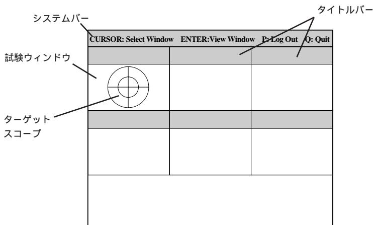
システムバーには、試験中に時間などの情報が表示されます。診断終了後には、ウィンドウを操作するキーの説明が表示されます。
