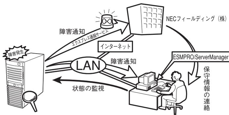
なお、本装置に障害が発生した際に、NECフィールドディング（株）がアラート通報を受信して保守を行う「エクスプレス通報サービス」を利用すれば、低コストでExpress5800シリーズの障害監視・保守を行うことができます。
