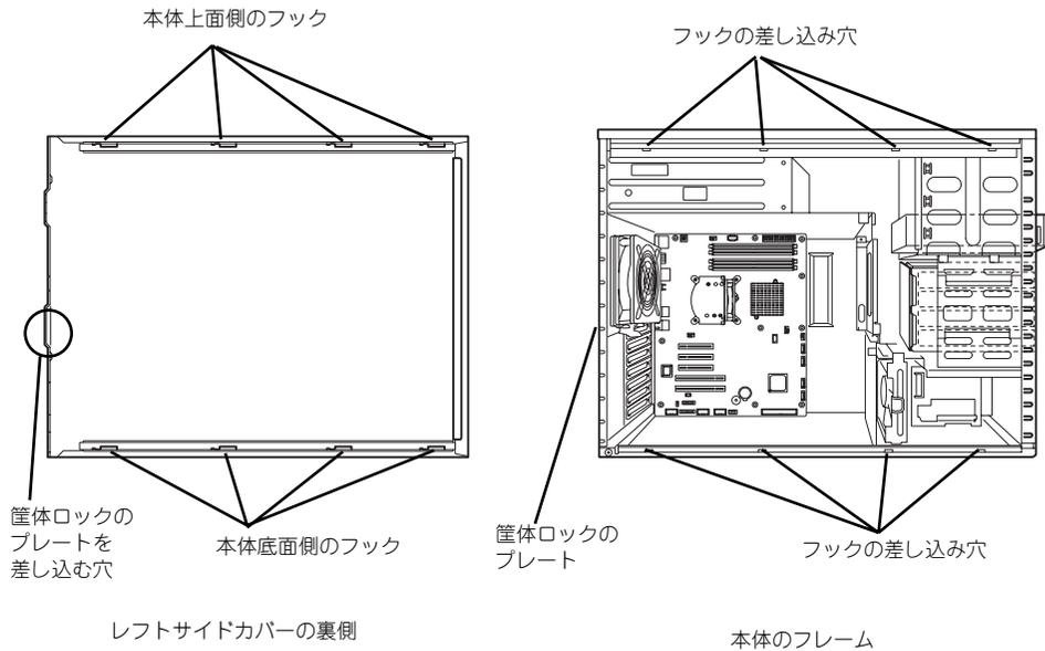
最後に取り外しの際に外したネジ（2本）でレフトサイドカバーを取り付けます。
