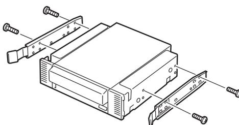
7. 左右のリリースタブを押しながら光ディスクドライブが入っていたスロットにデバイスをゆっくりと差し込む。
