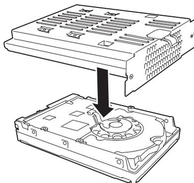
8. ネジ穴を合わせてネジ（左右2本ずつ）でハードディスクドライブをドライブキャリアに固定する。
