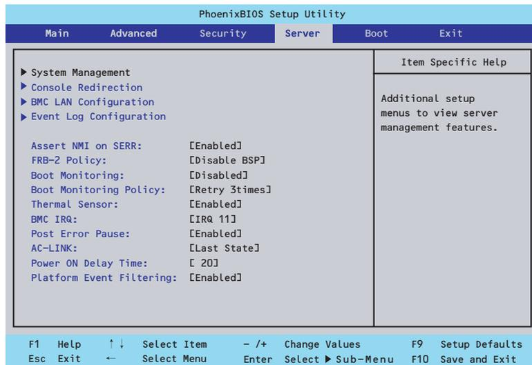
Serverメニューで設定できる項目とその機能を示します。「System Management」と「Console Redirection」、「BMC LAN Configuration」、「Event Log Configuration」は選択後、<Enter>キーを押してサブメニューを表示させてから設定します。
