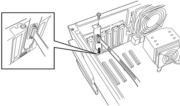
5. 他のPCIボードに緩衝しないようケーブルをフォーミングしてマザーボード上のシリアルポートBコネクタに接続する。
