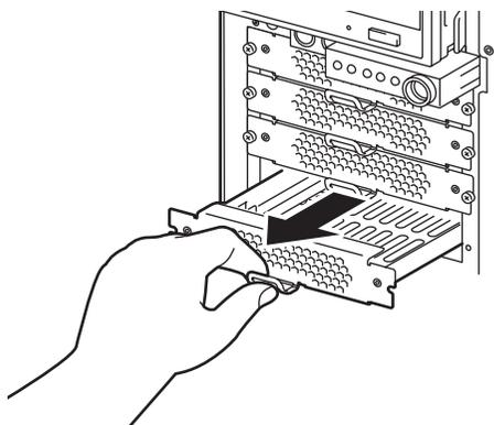
7. HDDケースを図に示す向きに持って本体へゆっくと差し込む。
