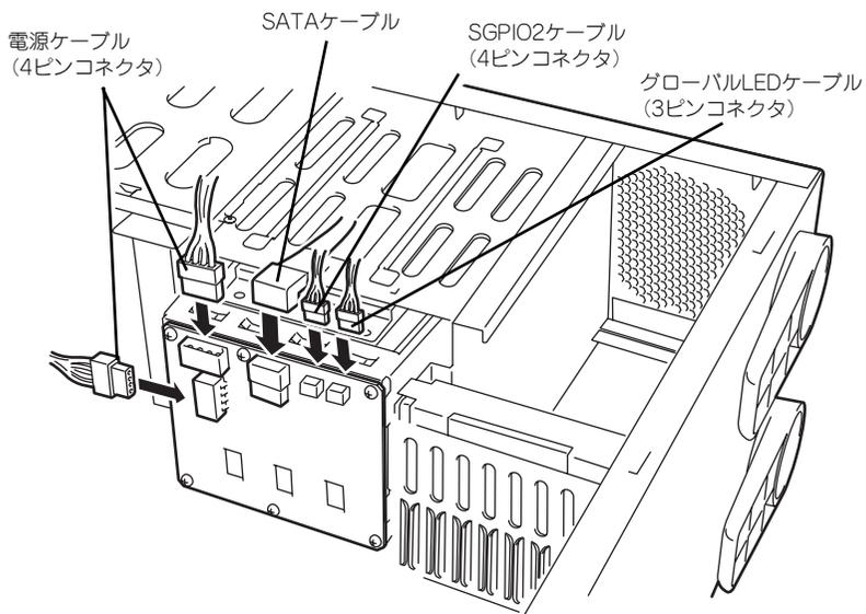
12. SGPIOケーブルとグローバルLEDケーブルをマザーボードに接続する。
