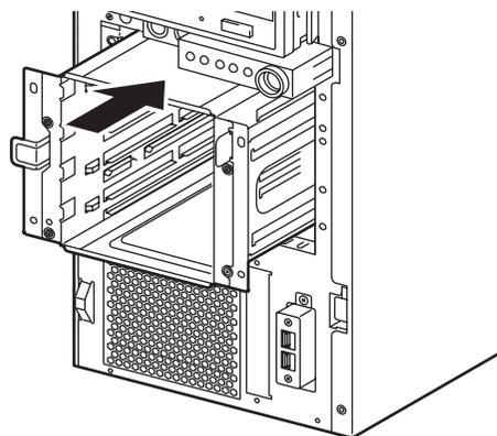
8. 増設HDDケースに添付のネジ（4本）で本体に固定する。
