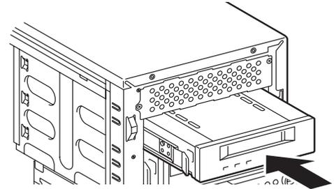
7. 装置側面から取り付けた5.25インチデバイスにインタフェースケーブルと電源ケーブルを接続する。
