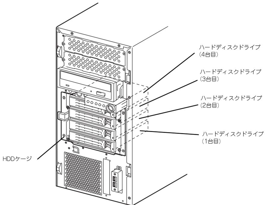
3.5インチハードディスクドライブ (Hotswap) を使用する場合は事前にN8154-15増設用3.5インチHDDケースを実装しておく必要があります。N8154-15増設用3.5インチHDDケースの取り付けは158ページを参照してください。
