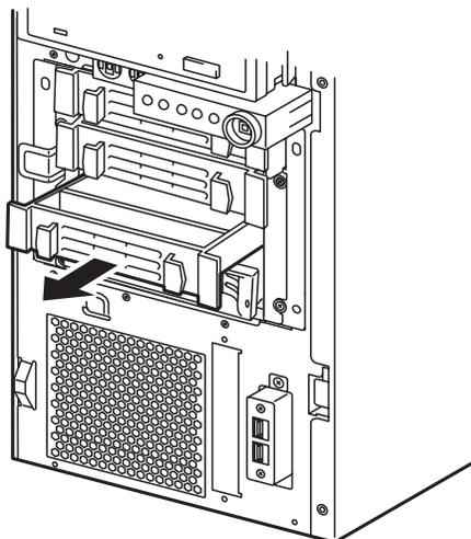
3. ハードディスクドライブをHDD ケージに取り付ける。
