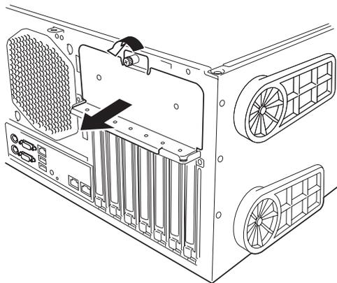
5. 取り付けるスロットと同じ位置（高さ）にあるスロットカバーを取り外す。
