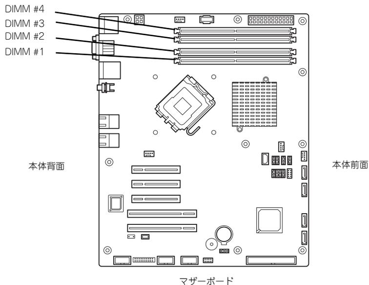
また、本装置ではメモリのDual Channelメモリモードをサポートしています。Dual Channelメモリモードで動作させるとメモリのデータ転送速度が早くなります。
