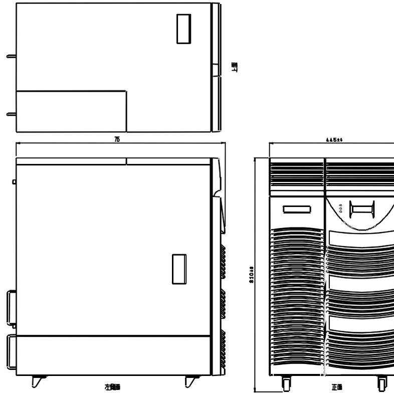
外形寸法：445(W) × 715(D) × 810(H)mm
