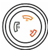
[N8142-28] NEMA L6-20P 用の コンセント形状 (AC200V) (工事必要)
