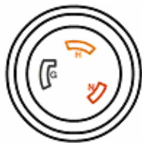
[N8142-17A] NEMA L6-30P 用の コンセント形状 (工事必要)
