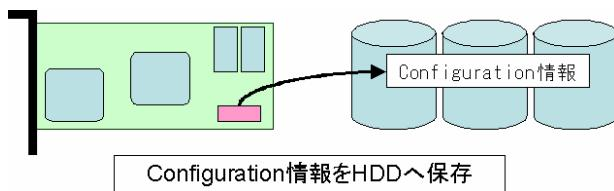
注意：故障や保守交換時など、交換したディスクアレイコントローラにコンフィグレーション情報がすでに存在している場合、ディスクアレイコントローラ内のコンフィグレーション情報をクリアしてから HDD を接続してください。
