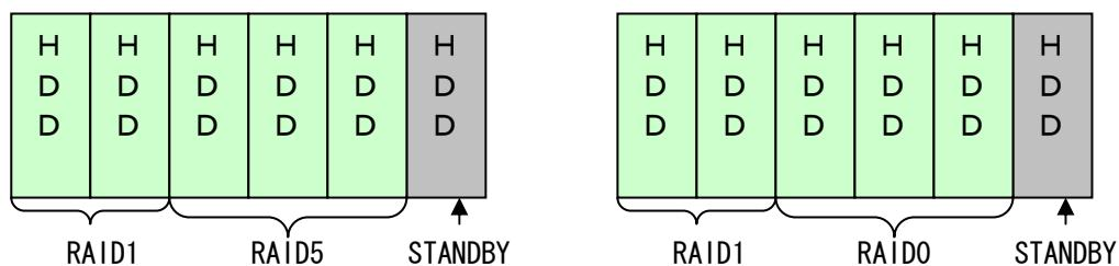
③大規模システム例 (HDD 6 台・・内部ケージ HDD14 台・・外部 DISK 増設筐体)
