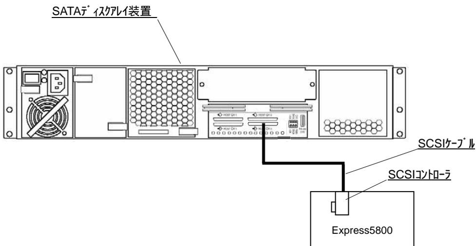
また、以下の図のように 1 台のサーバに SCSI コントローラを 2 枚実装し、2 台の SATA ディスクアレイ装置をサーバに接続することもできます。
