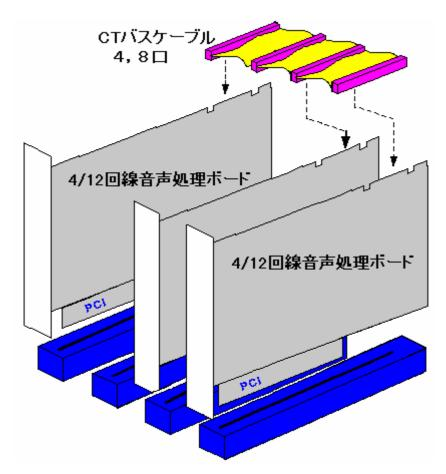
注) CT バスケーブルのコネクタ両端は、必ずボードの CT バスコネクタに接続してください。 5 枚以上実装する場合や、4 枚まででも実装条件によりケーブル長が足りない場合は、 8 口の CT バスケーブル( K410-109(00) )を使用してください。
