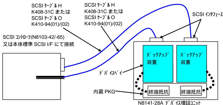
\* デバイスベイを 2 スロット占有するバックアップ装置を 2 台接続したい場合の例
