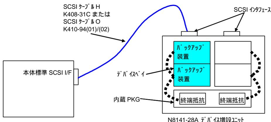
\* デバイスベイを 1 スロット占有するバックアップ装置を 2 台接続したい場合の例
