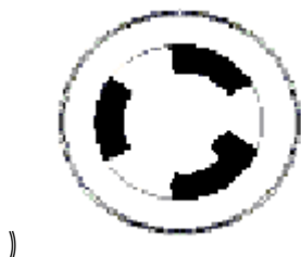
[N8142-17] NEMA L6-30P 用の コンセント形状 (工事必要)
