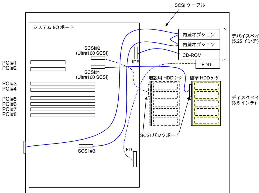
\* 5.25 インチデバイスに接続される SCSI ケーブルのコネクタは 68 ピン(Wide)であり、50 ピンに変換する変換コネクタが標準で装着してある。50 ピンのデバイスを使用する場合は、変換コネクタを装着したまま接続し、68 ピンのデバイスを使用する場合は、変換コネクタを取り外して接続する事。
