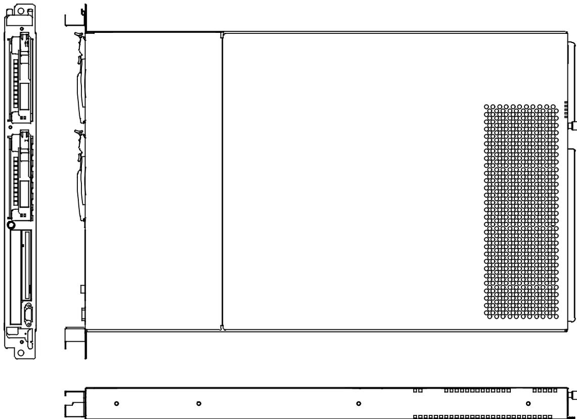
外形寸法 : 483(W) × 696(D) × 44(H)mm
