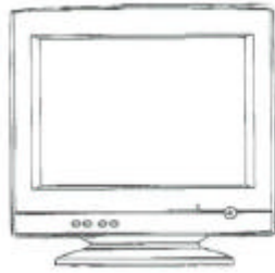
(N8571-21) 筐体寸法 365.0mm(W) × 396.5mm(D) × 369.0mm(H)
