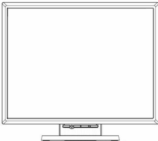
(N8171-44/44W) 筐体寸法 442(W) × 220(D) × 388.5~498.5(H)mm
