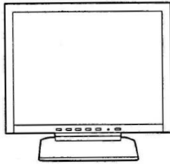
(N8171-34) 筐体寸法 343(W)×170(D)×308(H)mm
