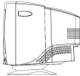
(N8171-30) 筐体寸法 363(W)×398(D)×374(H)mm
