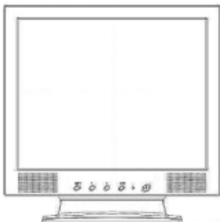
(N8171-35) 筐体寸法 420(W)×180(D)×418(H)mm
