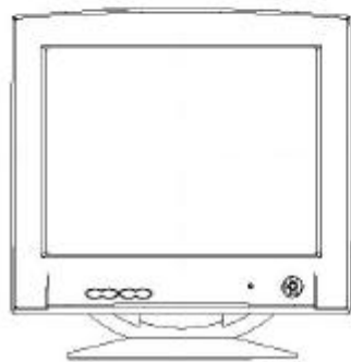
(N8171-30) 筐体寸法 363mm(W) × 398mm(D) × 374mm(H)
