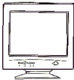
(N8571-15) 筐体寸法 403mm(W) × 440mm(D) × 427mm(H)
