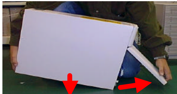
写真 1：前面パネルが外れた状態
