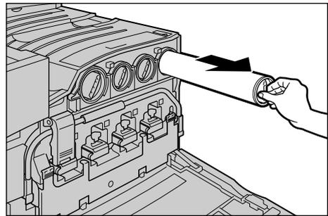
**4** 取り出したトナーカートリッジと同じ色の新しいトナーカートリッジを用意し、図のように、軽く3、4回上下左右によく振ります。
