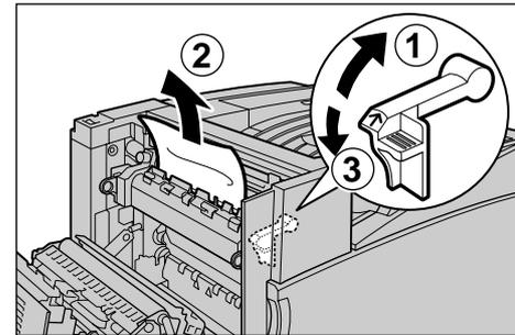
**5** L4 カバーの中央部を押して L4 カバーをゆっくりと閉じ、用紙トレイ 5（手差し）を上げます。
