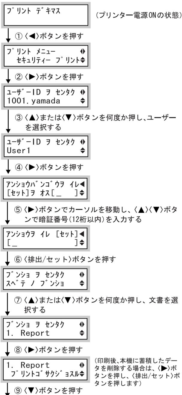
(印刷後、本機に蓄積したデータを削除する場合は、<▶>ボタンを押し、<排出/セット>ボタンを押します)
