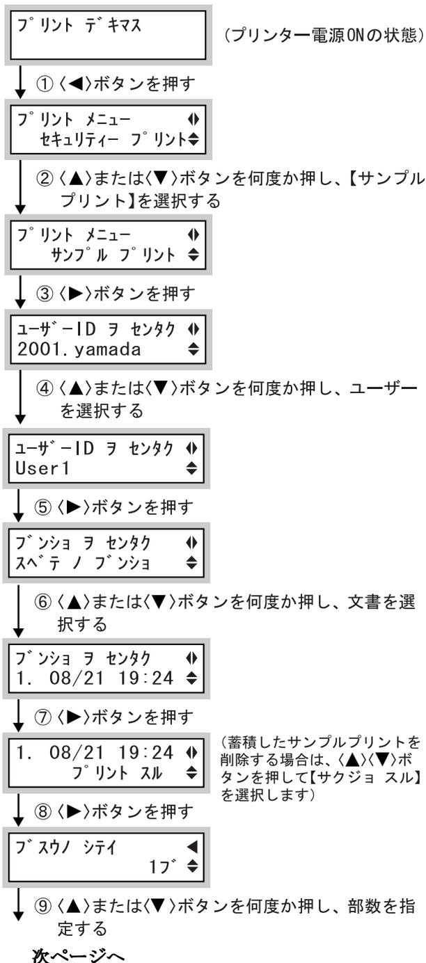
(蓄積したサンプルプリントを削除する場合は、<▲><▼>ボタンを押し、【サクジョスル】を選択します)
