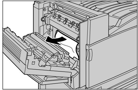
**4** 定着部（フューザーカートリッジ）に用紙が詰まって引き抜けない場合は、レバーを上げて（ ）、用紙を取り除きます（ ）。
