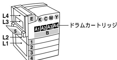
操作パネルの左にある表示部で、該当するドラムカートリッジの位置 ([ A1 ] [ A2 ] [ A3 ] [ A4 ]) を確認してから、交換してください。
