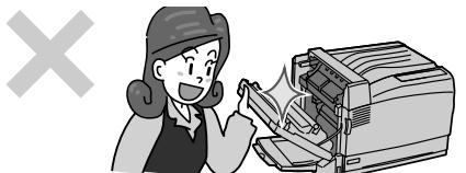
このプリンターはレーザー（レーザーダイオード）を使用しています。電源がONになっているときに内部をのぞいたり、鏡などを差し込んだりしないでください。万一、レーザー光が目に入ると失明するおそれがあります（レーザー光は目に見えません）。（このプリンターは、JIS C 6802規格に基づくクラス1レーザー製品です。）
