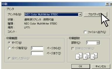
[プロパティ]をクリックするとプロパティダイアログボックスが表示されます。
